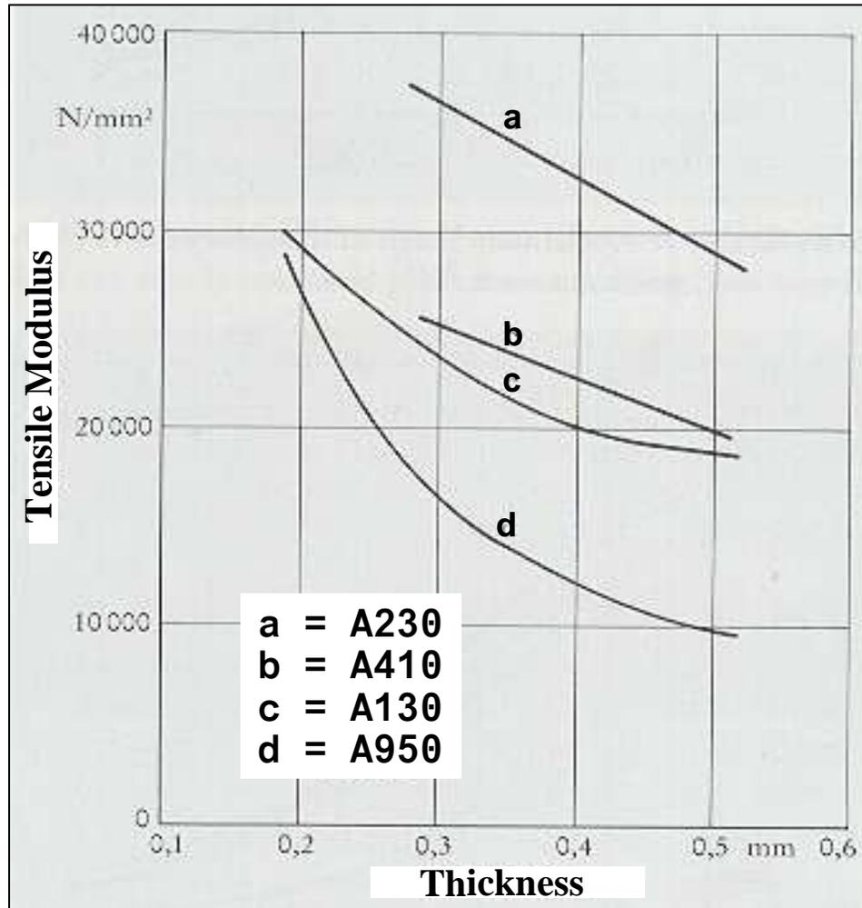
E-Modulus = f (wall thickness)
